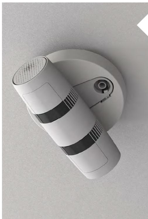
Der Sensor cogvisAI 3D-Smartsensor 2.0 kann Stürze verhindern, erkennen und analysieren. Er erfasst dreidimensional den Raum und erstellt ein 3D-Modell basierend auf den gemessenen Entfernungen. Dabei nutzt er eine Infrarot-Technologie, die keine persönlichen Daten erfasst. Das System kann weder die Person, das Geschlecht oder spezifische Aktivitäten erkennen.
